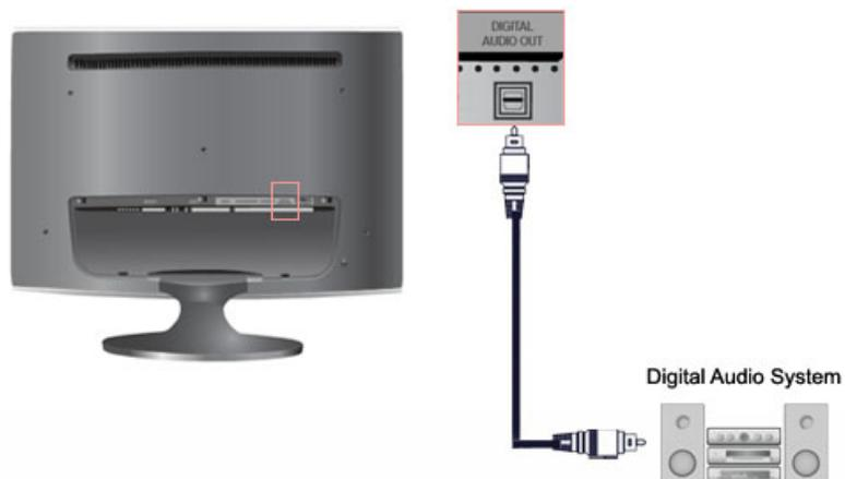
1. Ligue o terminal DIGITAL AUDIO OUT do monitor ao terminal de entrada de som digital do amplificador digital, utilizando um cabo óptico.
