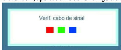
Esta caixa aparece durante o funcionamento normal, se o cabo de vídeo se desligar ou for danificado.
