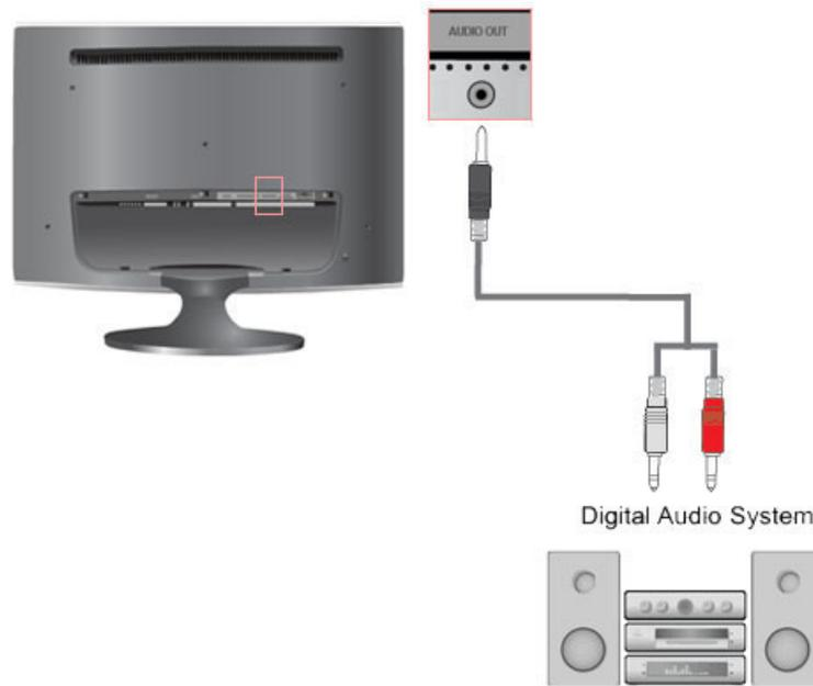
1. Ligue as tomadas vermelha e branca de um cabo RCA a estéreo (para PC) aos terminais de saída de áudio com as mesmas cores do dispositivo de saída digital e, em seguida, ligue a tomada oposta ao terminal [AUDIO OUT] do monitor.
