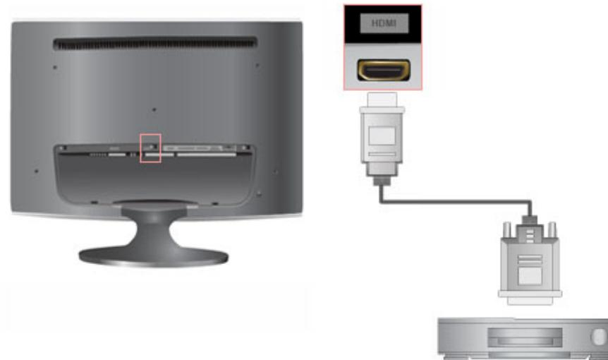
1. Utilize um cabo *DVI a HDMI* para ligar o terminal de saída *DVI* de um dispositivo de saída digital ao terminal *HDMI* do monitor.
