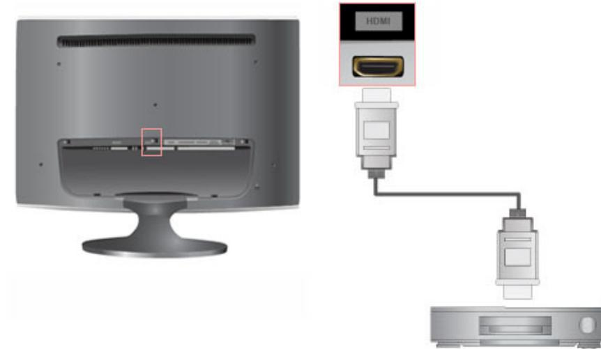
1. Os dispositivos de entrada como DVD digitais ligam-se ao terminal *HDMI* do monitor utilizando um cabo *HDMI*. Depois de fazer todas as ligações, ligue os cabos de alimentação do monitor e do DVD (ou do dispositivo ligado ao terminal de saída digital).
