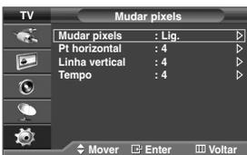
Este aparelho está equipado com tecnologia de prevenção contra 'queimadura de ecrã', o que reduz a possibilidade de ocorrência deste efeito. Esta tecnologia permite regular o movimento da imagem para cima/baixo (Linha vertical) e lateralmente (Ponto horizontal). A definição Time (tempo) permite programar, em minutos, o tempo entre movimentos da imagem.
