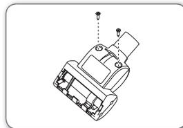
2. Inspectez l'état de la brosse rouleau. Remplacez la brosse rouleau lorsque les poils sont usés. Pour retirer la brosse rouleau, tirez-la vers le haut et sortez-la des logements d'extrémité dans le boîtier du suceur. Insérez les extrémités de la brosse rouleau dans les mêmes logements pour la replacer.
