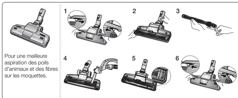
Une aspiration fréquente des cheveux ou des poils d'animaux peut entraîner un ralentissement de la rotation en raison d'un enchevêtrement de ces éléments autour de la brosse. Dans ce cas, nettoyez la brosse avec précaution.
