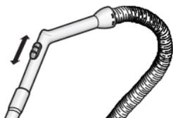
Diminue l'effet de succion pour l'adapter au nettoyage de draperies, tapis ou autres petits objets ; tirer sur la capsule de sortie d'air pour l'ouvrir.
