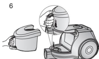
Avant d'utiliser l'aspirateur, mettre en place le réceptacle jusqu'à l'écoute du (clic).
