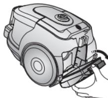
Appuyer sur le cadre de la partie arrière du corps principal pour enlever le filtre de sortie.
