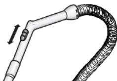
Diminue l'effet de succion pour l'adapter au nettoyage de draperies, tapis ou autres petits objets ; tirer sur la capsule de sortie d'air pour l'ouvrir.
