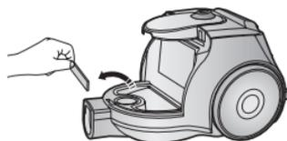
Enlever le filtre de protection du moteur de l'aspirateur. Le secouer et le battre pour enlever la saleté et le remettre ensuite en place.
