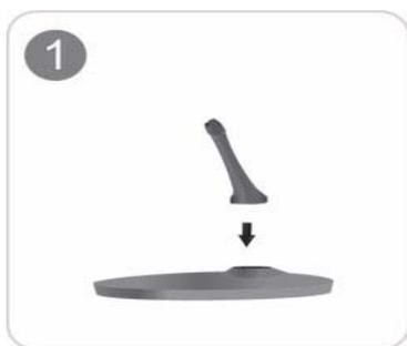
Insérez le connecteur du pied dans le pied, dans le sens indiqué sur l'illustration.
