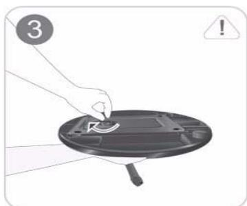
Tournez complètement la vis de connexion dans le bas du pied, de façon à ce qu'il soit solidement fixé.
