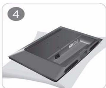
Posez un chiffon doux sur la table, afin de protéger l'appareil. Posez l'appareil sur le chiffon de telle façon que sa partie avant soit tournée vers le bas.
