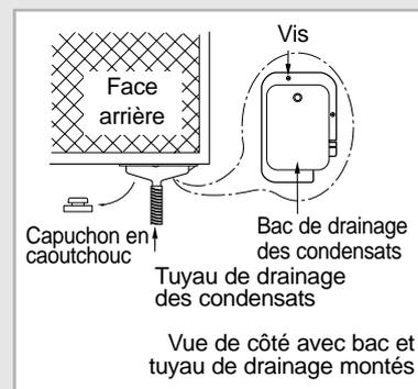
◆ **Si le bac de drainage des condensats peut être directement monté à l'arrière de l'appareil après installation du climatiseur:**
