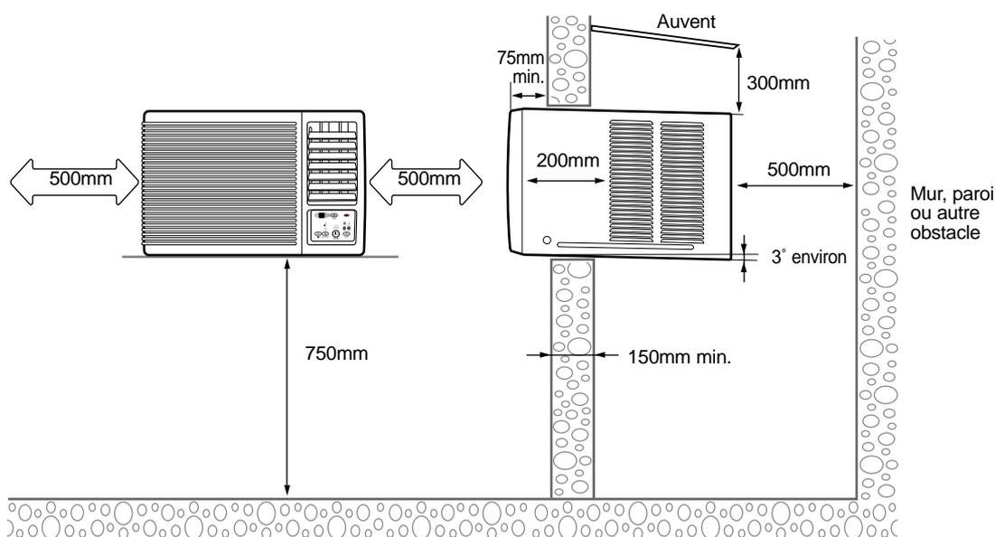
◆ Si le mur fait plus de 150mm de large, l'entailer à un angle de 45°, si possible.
