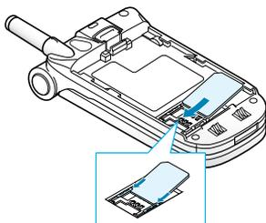
**Remarque :** pour retirer la carte, dégagez-la avec précaution du dispositif de fixation dans le sens indiqué par la flèche.
