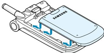
5. Faites coulisser la batterie vers le haut du téléphone jusqu'à ce qu'un déclic retentisse. Avant d'allumer le téléphone, vérifiez que la batterie est correctement installée.
