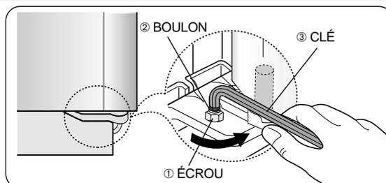
2) Ajustez la différence de hauteur entre les portes en tournant le boulon (②) dans le sens des aiguilles d'une montre (↻) ou dans le sens inverse (↺).
