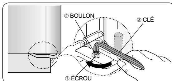
3) Après avoir ajusté les portes, tournez l'écrou (①) dans le sens des aiguilles d'une montre (↻) jusqu'à la base du boulon, puis resserrez le boulon à l'aide de la clé (③) pour fixer l'écrou (①).
