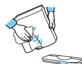
4. Après avoir nettoyé le mécanisme d'alimentation en eau à l'aide d'une brosse souple, appuyez sur le levier et nettoyez-le sous l'eau courante.
