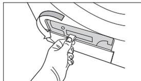
2. Déverrouillez la fixation du condensateur.
