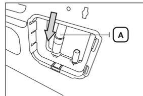
3. Raccordez le tuyau fourni (tuyau de vidange long) **B** à l'orifice situé à côté de celui raccordé au tuyau de vidange **A**.
