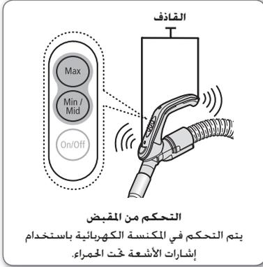
١. تشغيل/إيقاف المكينة الكهربائية
