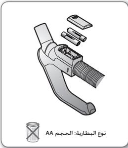
١. إذا لم تعمل المكنسة الكهربائية، استبدل البطاريات. وإذا استمرت المشكلة، يرجى الاتصال بالموزع المعتمد الخاص بنا.
