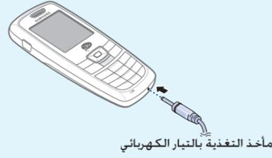
مأخذ التغذية بالتيار الكهربائي
