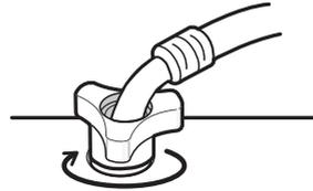
3. 检查是否有漏水情况。确保进水管连接牢固。
