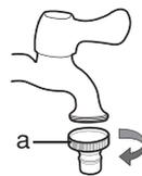
2. 将 b 部分的进水管接头以逆时针的方向与水龙头连接，然后用手拧紧。
