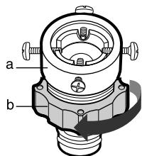
5. 以顺时针方向将进水管的另一端拧紧在洗衣机进水口上。
