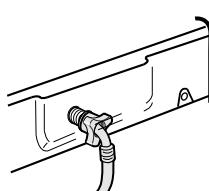
3. 连接器套上水龙头，并向上与水龙头靠紧后，用螺丝锁紧，再转螺母b部分使ab合并。
