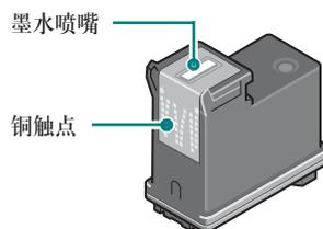
**6** 将打印墨盒的铜箔朝向打印机，然后放入打印墨盒的支架并与支架保持一定的角度。
