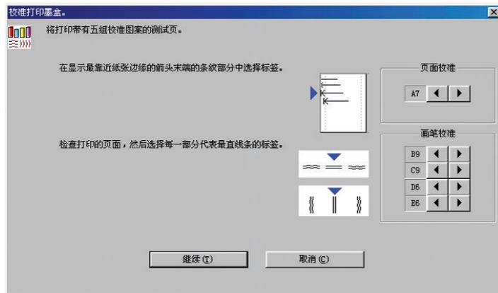
9 查找表中每一个校准图形下面的线和号码，选择表中最直的线。
