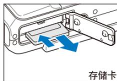
轻轻推动存储卡，使存储卡与相机分离，然后从插槽中拉出。
