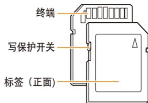
使用 SD 或 SDHC 卡上的写保护开关，可避免文件被删除。向下滑动开关锁定，向上滑动解除锁定。拍照时请解除锁定。
