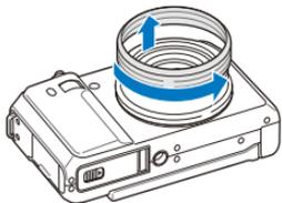
2 顺时针旋转，将转换镜头安装到相机上。
