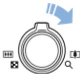
在“播放”模式中，向右旋转 [变焦] 放大图像的一部分。向左旋转 [变焦] 以缩小。
