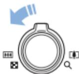
在“播放”模式中，向左旋转 [变焦] 查看缩略图（每次 9 张）。向左旋转 [变焦] 一或两次以显示更多缩略图（每次 16 张或 36 张）。向右旋转 [变焦] 返回之前画面。
