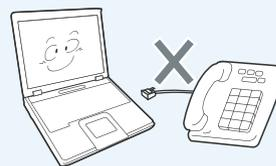
不要将与数字电话相连的电话线连接到调制解调器。
