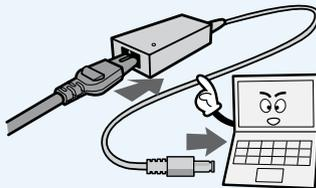
不要在电源线或交流电适配器上放置重物或者用脚踩，以免损坏电源线或交流电适配器。
