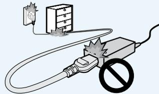
请将电源线牢牢连接到交流电适配器。
