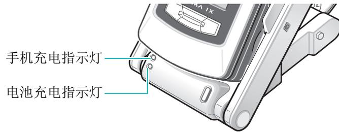
6. 当指示灯变绿时，从充电座取出 PDA 或电池。如欲取出 PDA，如下图所示，先向外轻拉 PDA，然后拨出 PDA。
