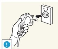
从电源插座上拔下电源线时，请抓住电源插头。
