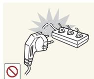
请勿将多个产品的电源插头连接到一个电源插座。
