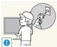
在搬移本产品之前，请先关闭电源开关，并拔下电源线及所有其他连接的缆线。
