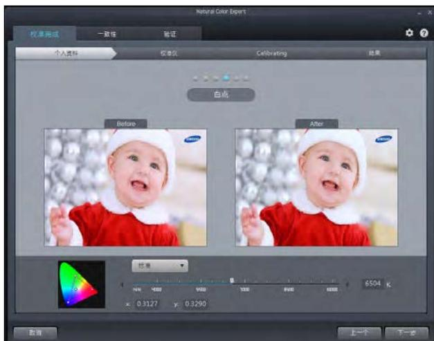
6 配置R/G/B 灰度系数设置。如果您配置 LUT，系统将应用 sRGB 的伽玛曲线。
