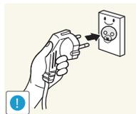
将电源插头连接到接地的电源插座（仅限 1 级绝缘装置）。
