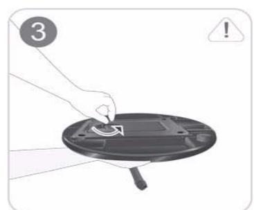
拧动支架底部的连接螺钉，将它拧开。
