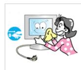
清洁本产品时，请先断开电源线的连接，再用柔软的干布进行清洁。
