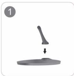
按照如图所示的方向，将支架支杆插入支架。
