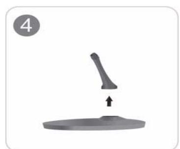
按照图中箭头所示方向拉动支架支杆，将支架支杆从支架上取下。
