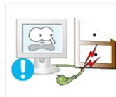
切勿过度弯折或缠绕电源线并避免在电源线上放置重物。
