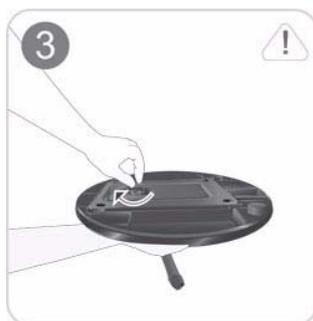
拧紧支架底部的连接螺钉，将支杆牢固固定。
