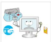
如果打雷或闪电，请拔下电源线，绝对不可以触碰天线缆线，否则会有危险。
