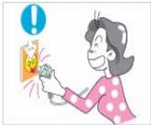
在从墙壁插座上拔下电源插头时，请确保抓住电源插头将插头拔下，切勿抓住电源线拔插头。
