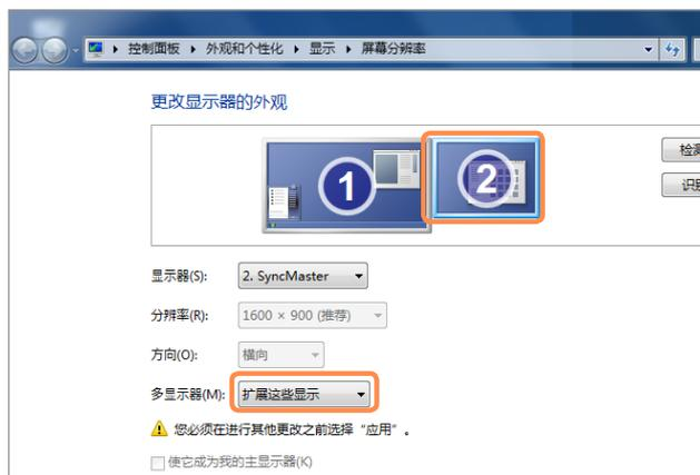
**3** 当笔记本电脑的 LCD 设置为主设备时, 数字 1 显示在主显示设备上, 数字 2 显示在辅助显示设备上。现在就能将桌面屏幕扩展到两台显示设备上了。
