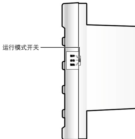
**备注** ◆ 使用运行模式开关，用户可在“制冷/自动/制热”等方式中选择空调器的运行模式。
