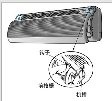
2 抬起空气过滤网的底部边缘后，向下拉以取下过滤网。
