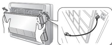
2. 抓住手柄，轻轻下按并弯曲空气过滤网。接着将空气过滤网拉向自己并向
