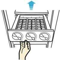
4. 轻扭旋转制冰盒旋钮，放手后冰块自动落入下面冰盒内，拉出储冰盒即可取冰。
