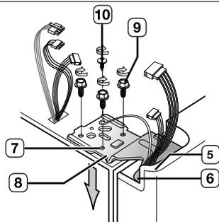
4. 重新连接上电线（不同型号连线的数量不同，连接时要按同类型的端子连接，正对插接，不要碰弯插针，并确认插接到位）。
