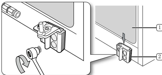
2. 将冷藏室门③角部的孔对准下部铰链④。
