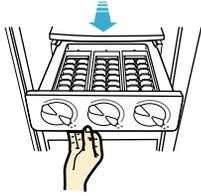
2. 把冷水倒入旋转制冰盒中，直到达到冰块盒上的水位指示标志为止。
