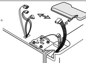
5. 将上部铰链盖⑪的前边沿放在上部铰链⑫的前面并重新安上螺钉。
