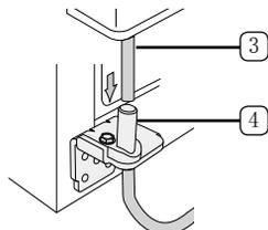
3. 将上部铰链轴插⑤到冷冻室门⑥上角的孔内。确保上部铰链孔⑦和储物柜孔之间的铰链处于水平状态⑧，顺时针旋转铰链螺钉⑨和地线螺钉⑩将其重新装上。
