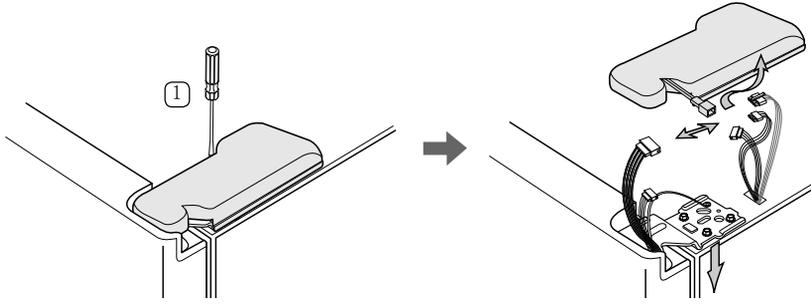
2. 逆时针旋转铰链螺钉②和地线螺钉③将其拆除并卸下上部的铰链④。小心冷藏室门在拆除过程中不要滑落。
