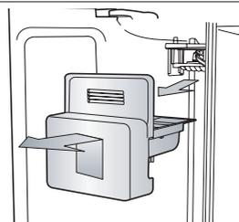
5. 同时打开冷冻室和冷藏室的门，拧掉 3 个螺钉。螺丝拧掉后就可以将支脚的前盖拆除。要重新安装前盖，只需将其放回原位，再拧上 3 个螺钉。
