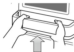
4. 酒瓶架安装在冷藏室的内胆侧壁上。(RSA1Z/RSA1S)
