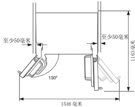
最主要的是要先测量门框（宽度与高度）、门槛、天花板、楼道等地方的尺寸，以确保可以轻松地将您的冰箱搬到指定的位置。
