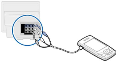
2. 将电视切换到外部输入模式。显示屏切换到电视输出模式，并且可在电视屏幕上查看手机显示内容。
