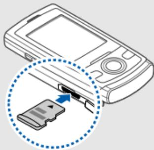
3. 推动存储卡到存储卡槽直到锁定为止。
