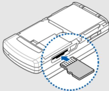
3. 推动存储卡到存储卡槽直到锁定到位。
