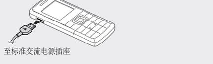
应首先拔下旅行充电器，然后从手机取出电池。否则，手机可能受到损坏。本机型不支持USB连接，所提供的USB线仅作充电使用。
