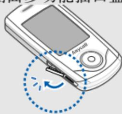
2. 将旅行充电器小端口插入插孔中。
