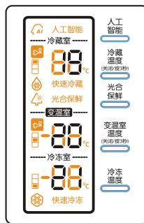
冰箱通电后，所有的显示亮2秒。2秒后进入人工智能运行，人工智能显示，冷藏室自动设定温度为5℃。冷冻室自动设定温度为-18℃，变温室自动设定温度为0℃，冷藏室、冷冻室、变温室均显示实际箱内温度。
