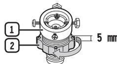
3. 将连接器连接至水龙头，同时向上提起连接器，并拧紧螺钉。然后，按箭头方向转动（2）部分，将（1）和（2）接在一起。
