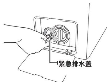
4. 捏住紧急排水管末端的盖子，缓缓拉出约 15 cm。
