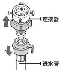
2. 首先，用十字螺丝刀松开连接器上的四个螺钉。然后，按箭头方向转动连接器（2）部分，直至出现一条 5 mm 缝隙。
