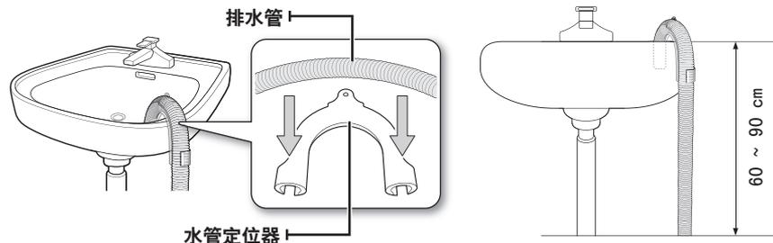
2. **连接水槽排水道分支** 排水道分支必须高于水槽吸水管，以确保洗衣机排水管离地至少 60 cm。
