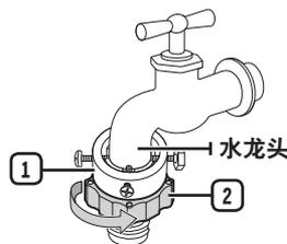
4. 将进水管连接至连接器。当您松开（3）部分时，伴随「喀哒」声水管将自动连接至连接器。
