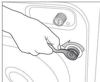
2. 抓住螺栓帽，将螺栓从宽松的孔位拉出。
