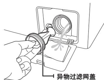
4. 清除异物过滤网上的所有污垢或其他杂物。确保异物过滤网背后的排水泵推进器未阻塞。
