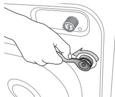
2. 抓住螺栓帽，将螺栓从宽松的孔位拉出。
