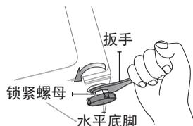
2. 调整水平底脚直到所需的高度，向左旋转为调高底脚。
