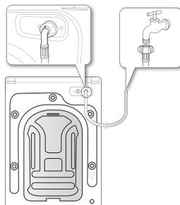
2. 将冷水进水管的另一端连接至水槽水龙头，并用手拧紧。
