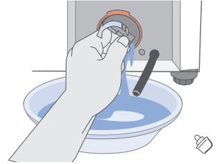
4. 清洗过滤器上的残渣和污渍。并确保排水泵内部没有被阻塞后，将残渣过滤器装回原位。
