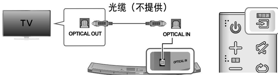
1. 将 Soundbar 上的 **OPTICAL IN**（音频）连接到电视的 **OPTICAL OUT** 插孔。
