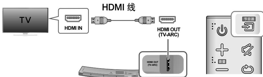
1. 将 HDMI 线从产品背面的 **HDMI OUT (TV-ARC)** 插孔连接至电视机的 HDMI IN 插孔。
