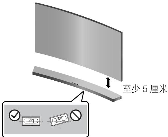
1. 将安装导轨放置在墙面上。
