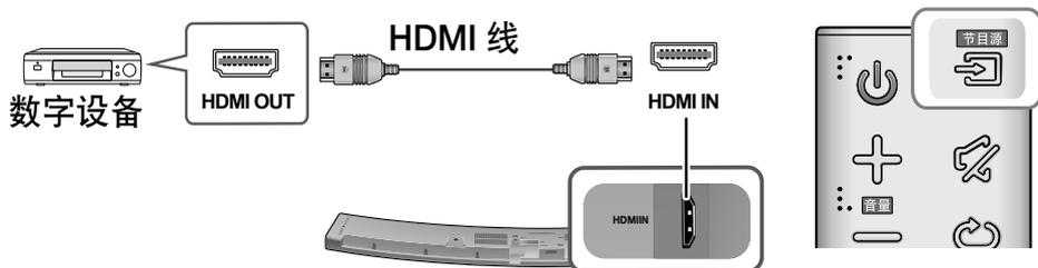
1. 将 HDMI 线从产品背面的 **HDMI IN** 插孔连接至数字设备的 HDMI OUT 插孔。
