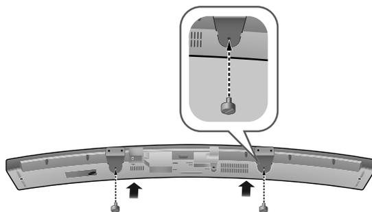
5. 将**支架固定螺丝**插入产品底面的每个孔中并固定它们。产品便已固定到**墙壁安装支架**。
