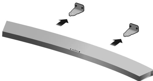
4. 插入**墙壁安装支架**后对齐产品，如图中所示。
