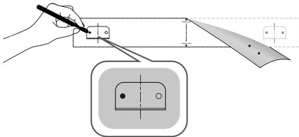
2. 用笔标记墙壁上要钉螺丝的位置，然后取下安装导轨。接着，使用大小适中的钻头钻孔安装螺钉。
