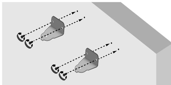
3. 将**墙壁安装支架**（2个）和螺丝固定到标记的位置。
