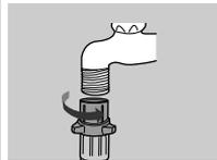
6. 如水喉屬螺絲頭型號，便需如圖中所示，採用適當的喉管來套上。
