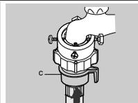
4. 將入水軟管接駁上接合器。將入水喉管(c)部分向下拉開後，只需再放回(c)部分，喉管便會自動彈合。
