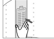
4. 關上蓋掩，先將過濾隔底部放入洗衣槽內，再將濾隔推入彈合。
