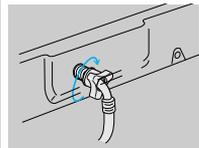
5. 將入水喉另一端與洗衣機頂部的入水活閥接駁一起。循順時針方向將喉管盡量扭緊。
