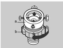
3. 將連接器套住水龍頭並上緊螺絲，如圖按箭頭方向旋轉(b)部份，使(a)(b)擰緊
