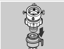
2. 首先，用[+]起子鬆開4個螺絲，然後抓住連接器，如圖按箭頭方向旋轉(b)部份，直到5mm的縫隙
