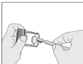
4. 洗掉所有污物或過濾網上粘附的其他物質。確定過濾網後的排水泵螺旋槳未堵塞。
