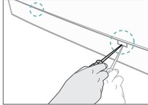
3. 向左擰緊急排水蓋，以將其卸下。抓住緊急排水管末端的排水蓋，慢慢地拉出約 15 公分。
