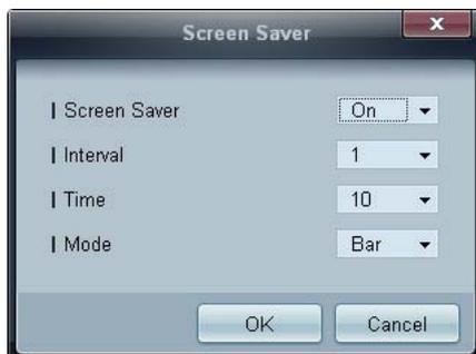
此功能可防止所選顯示裝置的螢幕長時間閒置時出現畫面烙印。
