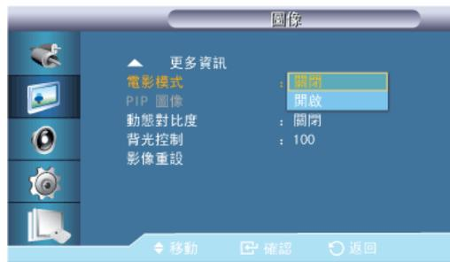
**電影模式** 在觀賞電視（30 個影格）上播放的電影（24 個影格）時校正不自然的圖像。
