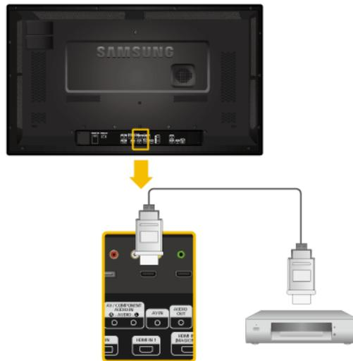
1. 將 HDMI 纜線連接至產品的 [HDMI IN 2 (MAGICINFO)] 或 [HDMI IN 1] 以及數位裝置上的 HDMI 輸出連接埠。
