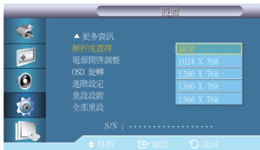
若螢幕上的圖像顯示不正常，則可以使用 Resolution Select (解析度選擇) 功能以 1024 x 768 @ 60Hz、1280 x 768 @ 60Hz、1360 x 768 @ 60Hz 或 1366 x 768 @ 60Hz 的解析度顯示圖像。
