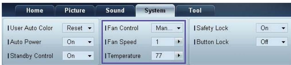
設定偵測用於保護產品之風扇速度與內部溫度所需的設定。
