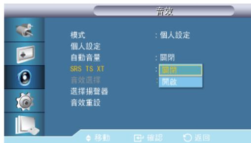
SRS TS XT 是一種 SRS 專利技術，可解決透過雙喇叭播放 5.1 多聲道內容的難題。TruSurround XT 可透過包括內置電視喇叭在內的任何雙喇叭播放系統提供出色的虛擬環繞聲。它與所有的多聲道格式完全相容。
