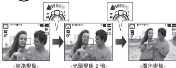
數位變焦「廣角」：在數位變焦模式下將變焦 W/T 桿向左移動以啟用數位變焦（軟體廣角）。停止移動變焦 W/T 桿以停止數位變焦操作。停用數位變焦時繼續向左移動變焦 W/T 桿可停用光學變焦（光學望遠）。
