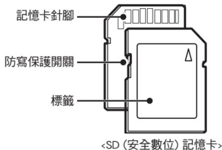
SD/SDHC 記憶卡有防寫保護開關，可避免刪除或格式化影像檔案。將 SD 記憶卡上的開關推至底部後，資料會受到保護。將 SD 記憶卡上的開關推至頂部，資料保護會取消。
