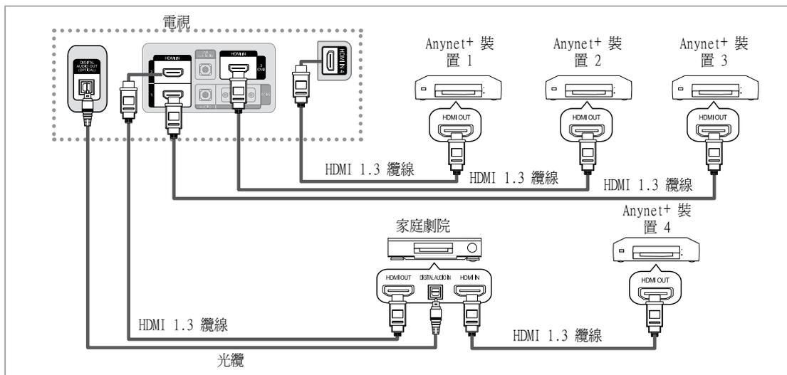
1. 使用 HDMI 纜線將電視上的 HDMI IN (1【DVI】、2、3) 插孔與相應 Anynet+ 裝置上的 HDMI OUT 插孔相連接。
