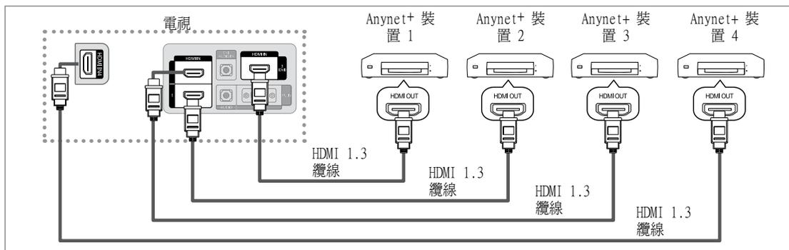
1. 使用 HDMI 纜線將電視上的 HDMI IN (1【DVI】、2、3) 插孔與相應 Anynet+ 裝置上的 HDMI OUT 插孔相連接。
