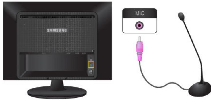
1. 將麥克風纜線連接至顯示器上的 MIC 連接埠。
