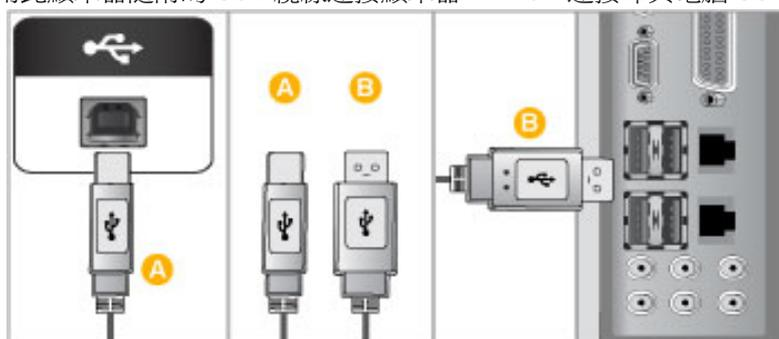
2. 透過 USB 纜線連接 USB 顯示器的 DOWN 連接埠與 USB 裝置。
