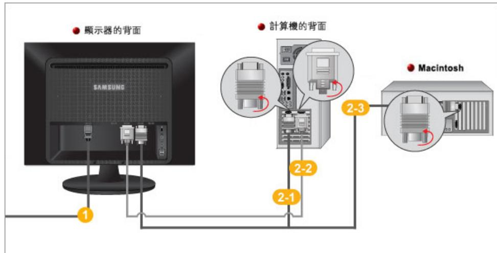
1 將顯示器的電源線連接至顯示器背面的 power 連接埠。
