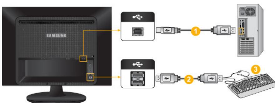
1. 透過 USB 纜線連接顯示器的 UP 連接埠與電腦的 USB 連接埠。
