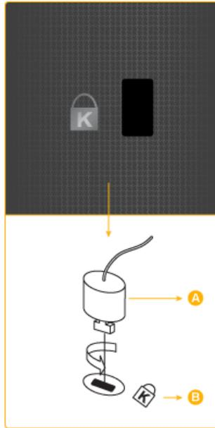
Kensington 防盜鎖是用於在公眾場合使用本系統時固定系統的裝置。鎖定裝置必須單獨購買。因製造商的不同，產品外觀和鎖定方法可能與圖解中有所不同。請參閱 Kensington 防盜鎖隨附的手冊，正確使用該產品。鎖定裝置必須單獨購買。
