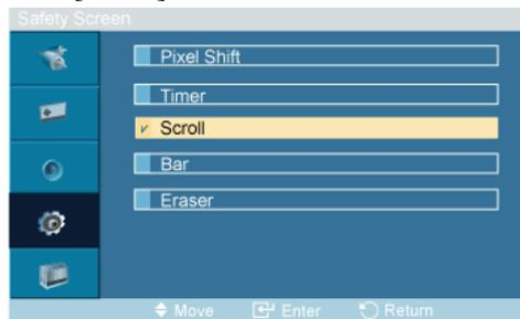
此功能可以根據圖案移動 PDP 上的所有像素，從而防止螢幕上出現殘影。
