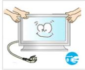
▶ 移動產品時，請關閉電源並拔下電源插頭、天線纜線以及連接至產品的所有纜線。
