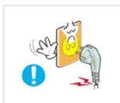
▶ 切勿使用損壞的電源線或插頭以及損壞或鬆動的電源插座。
