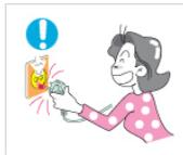
▶ 要斷開設備與電源的連接，必須將插頭從電源插座上拔除，因此電源插頭應容易操作。
