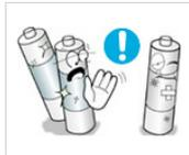
▶ 請只使用指定的標準電池，切勿混用新電池和舊電池。
