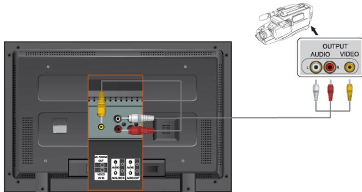
1. 找到攝錄影機的 AV 輸出插孔，它們通常位於攝錄影機的側面或背面。使用一組音訊纜線連接攝錄影機上的 AUDIO OUTPUT 插孔和 LCD 顯示器上的 AV AUDIO IN [L-AUDIO-R]。
