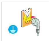
▶ 請務必將電源線連接至接地的電源插座。
