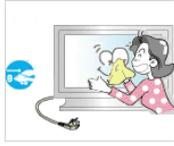
▶ 清潔產品時，請先拔下電源線，然後用乾布輕輕清潔。
