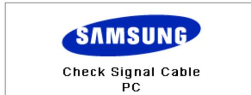
4. 關閉您的 LCD 顯示器並重新連接視訊纜線，然後再開啟電腦和 LCD 顯示器。
