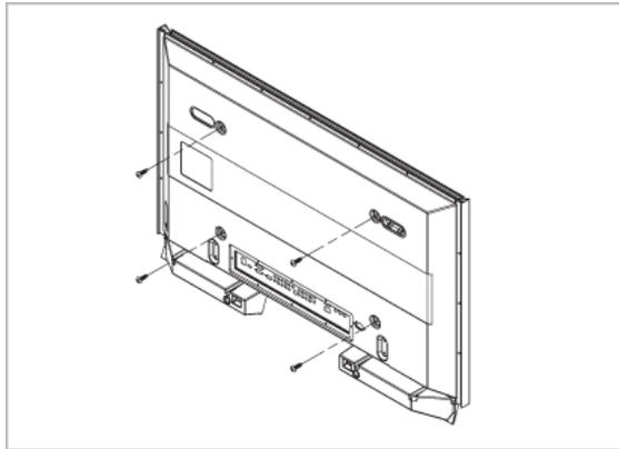
4. 去除安全栓 (3) 並將 4 個產品套柄插入相應的托架孔 (1)。然後，放置產品(2)，確保其牢固地固定在托架上。切記重新插入並固定安全栓 (3)，確保產品穩固安裝在托架上。
