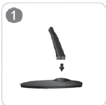
如圖所示，將支架連接器從合適方向插入支架。
