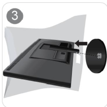
按圖中所示方向將支架底座插入支架連接部件。
