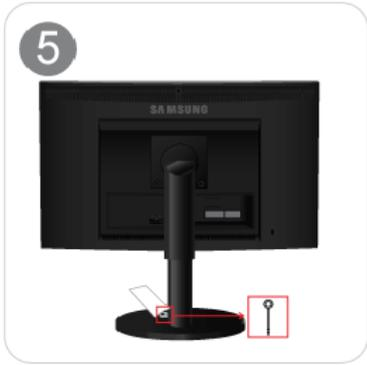
底座安裝完畢之後，按圖中所示立起顯示器。現在可拔出止動銷，以便調整支架。
