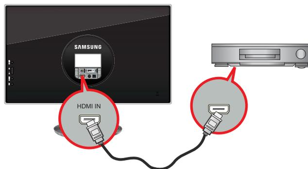
2. 使用 HDMI 至 DVI 纜線連接數位輸出裝置的 DVI 輸出連接埠與本產品的 [HDMI IN] 連接埠。
