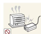
務必使電源變壓器遠離任何其他發熱源。
