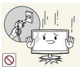
若產品掉落或外殼受損，請關閉電源並拔下電源線。然後聯絡服務中心。
