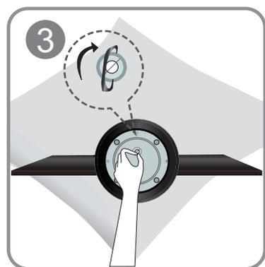
旋轉支架底部的連接螺絲，直至完全固定到位。
