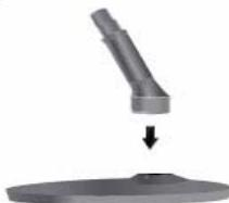
如圖所示，將支架連接器從合適方向插入支架。
