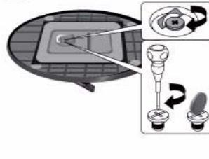
旋轉支架底部的連接螺絲，直至完全固定到位。
