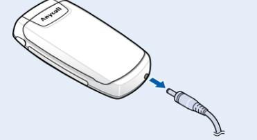
註：請勿在拔出充電器之前取出手機電池，否則可能損壞手機。
