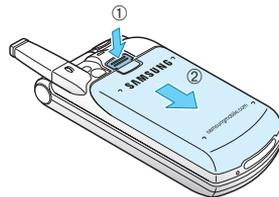
3. 如圖所示，將SIM咭滑入SIM咭架並將其鎖定入位。確保凹角位於左上角，咭的金色觸點朝向手機。
