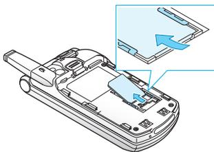
4. 放入電池，小心地將電池上的凸片與手機內的插槽對齊。
