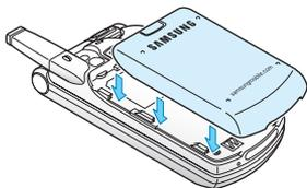
5. 將電池向手機頂部位置滑動並緊扣在手機上。在啓動手機前，請確保電池安裝正確。
