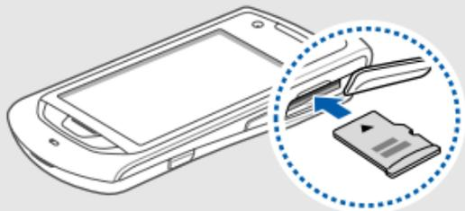
3. 将存储卡推进存储卡插槽直至锁定到位。
